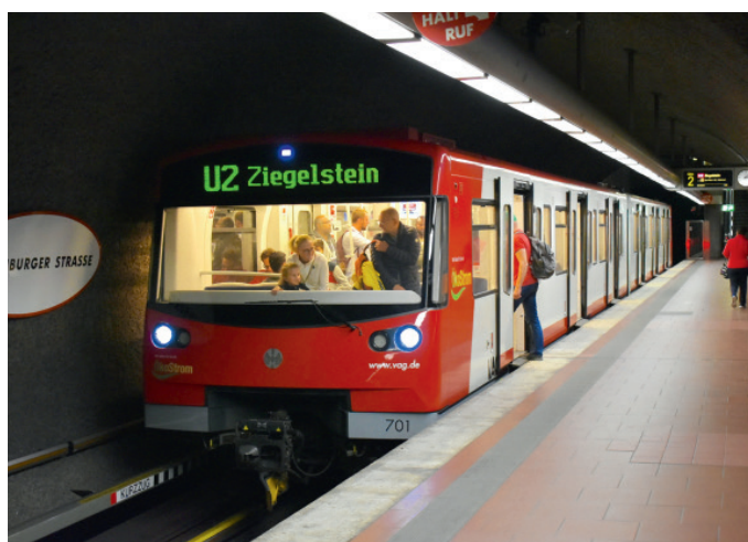
Abb. 2: Die Nürnberger U-Bahnlinien U2 und U3 verkehren als einzige in Deutschland vollautomatisch ohne Fahrer.
